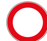
Fig. 46 DIVIETO DI TRANSITO
